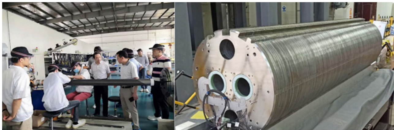
图一：首套 HL-LHC CCT 磁体研制完成并通过 4K 性能测试
